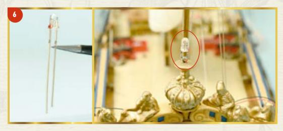
6 Теперь установим светодиод. Пометьте положительный контакт (он более длинный), а затем обрежьте по размеру контакты и провода. Припаяйте контакты светодиода к проводам, соблюдая полярность.
